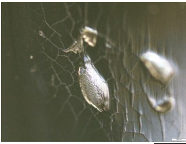
図1 光学顕微鏡による使用済み TiCN サーメット A の表面観察
