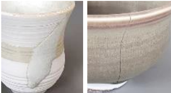
図 7 釉薬のトラブル例 (左:釉はげ 右:シバリング)
