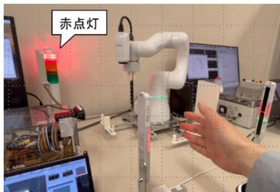
図5 エアロセンサによる表示灯の制御(赤点灯)
