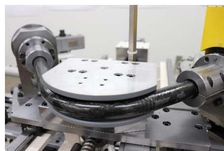
図2 直角への曲げ加工の状況
