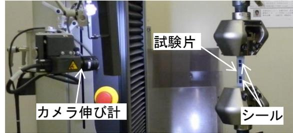
図1 カメラ伸び計を用いた引張試験
