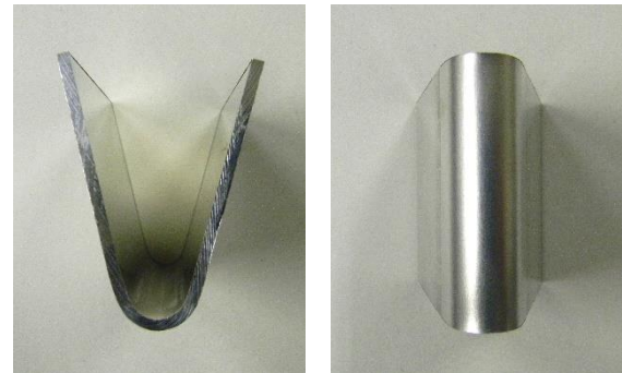
図3 曲げ試験片 条件① r=5 、 l=16 (mm)
