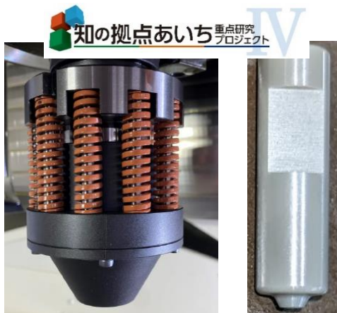
押圧 FSW 装置(左)と高耐熱セラミック FSW 工具(右)
