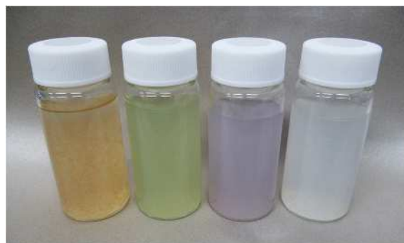
図2 様々な色彩の「三河木綿CNF」 (染色工程不要、高分散性素材)
