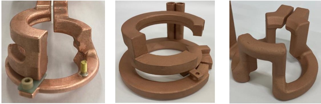
図4 設計自由度を活かした各種積層造形コイルの例
