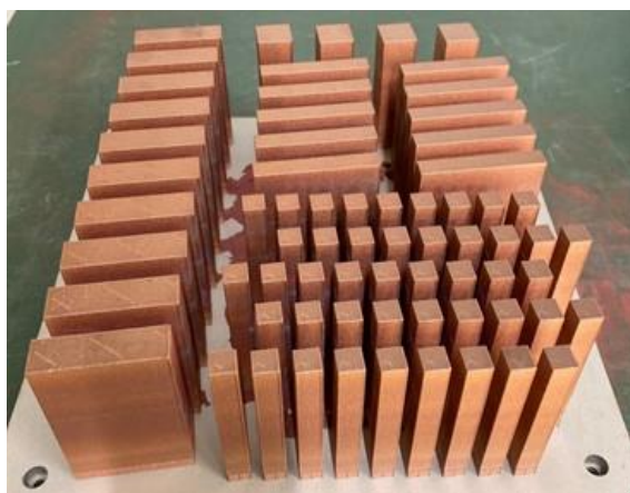
図6 材料評価に用いた L-PBF 法による銅合金積層造形物
