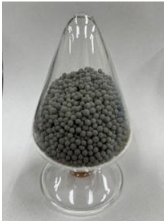
開発した高性能メタン合成触媒
