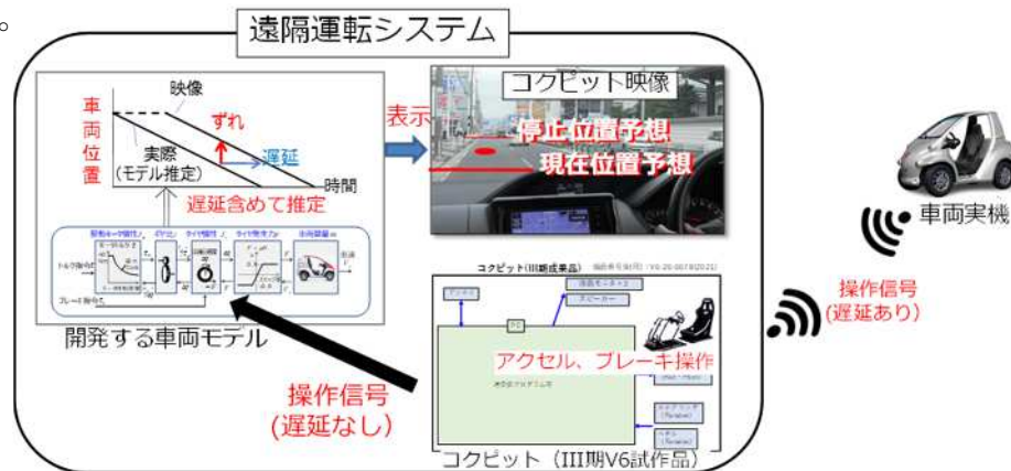
図5 遠隔運転の通信遅延対策技術
