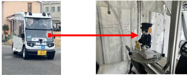
図4 車内ロボットを用いた状況説明技術 助手席付近にロボットを設置
