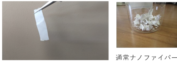
図3 紡糸後の#12と通常の酸化チタンナノファイバー
