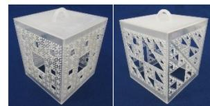
図10 アクリル系樹脂で造形した照明具モデル(左:シェルピンスキーのカーペット、フラクタル性の範囲が4、右:シェルピンスキーのガスケット、フラクタル性の範囲が5)
