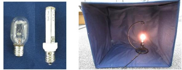
図 2 左から白熱電球、LED 電球、暗箱(42×35×34cm)
