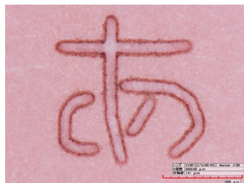
図 1 スパッタ膜作製用に用いた紙製マスク (マイクロスコープ像)
